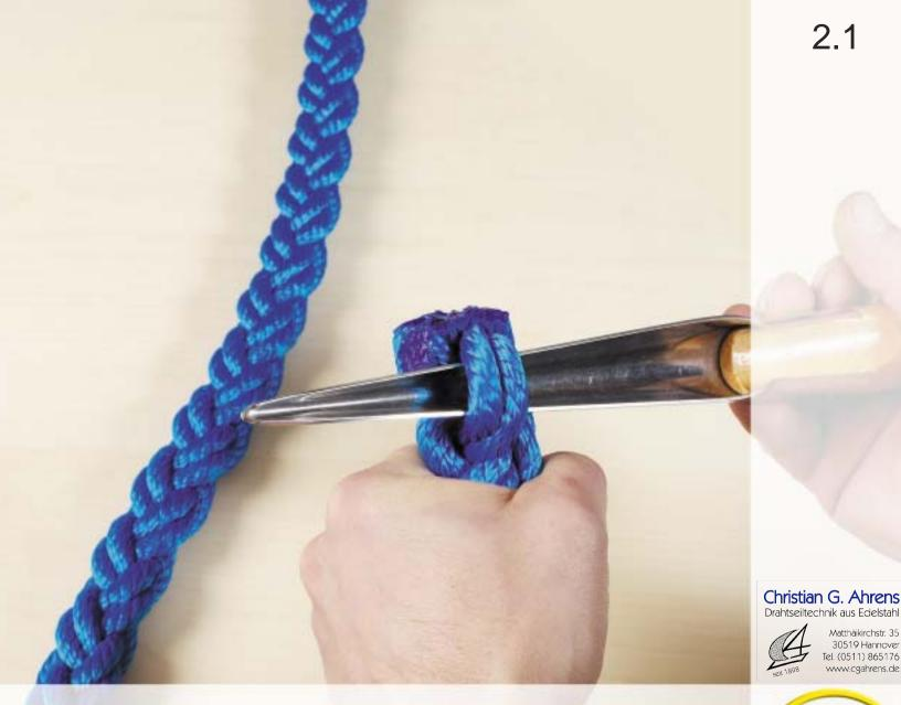
Öffnen des abgeschweißten Seiles mit dem Hohlspieker. Seil entfaltet sich in 4x2 Teile (Litzen).
