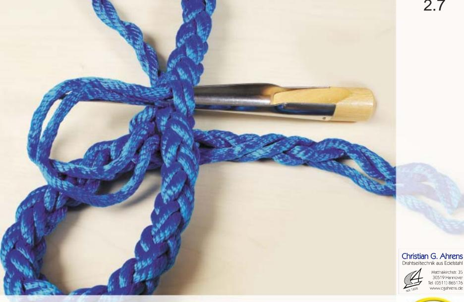
Jetzt die 2 Litzen von links mit Hilfe des Hohlspiekers unter 2 Litzen einführen.
