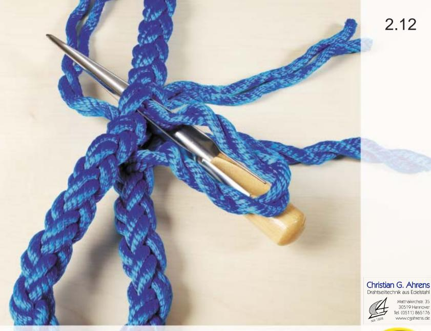
Jetzt die 2 Litzen von rechts mit Hilfe des Hohlspiekers Unter 2 Litzen einführen.
