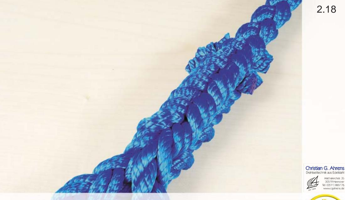
Fertiger Spleiß (Überstände passen sich durch Spannung dem Seil an).
