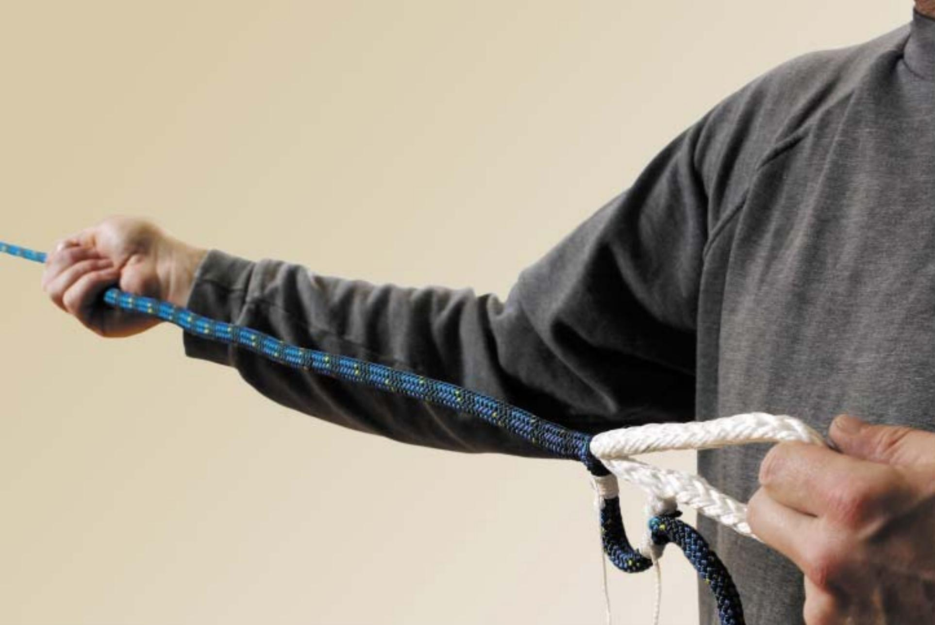
Den in Schritt 1.1 gemachten Knoten an geeignetem Haken oder Pfosten einhängen. Mantel in Richtung des gespleißten Auges zurückmelken.
