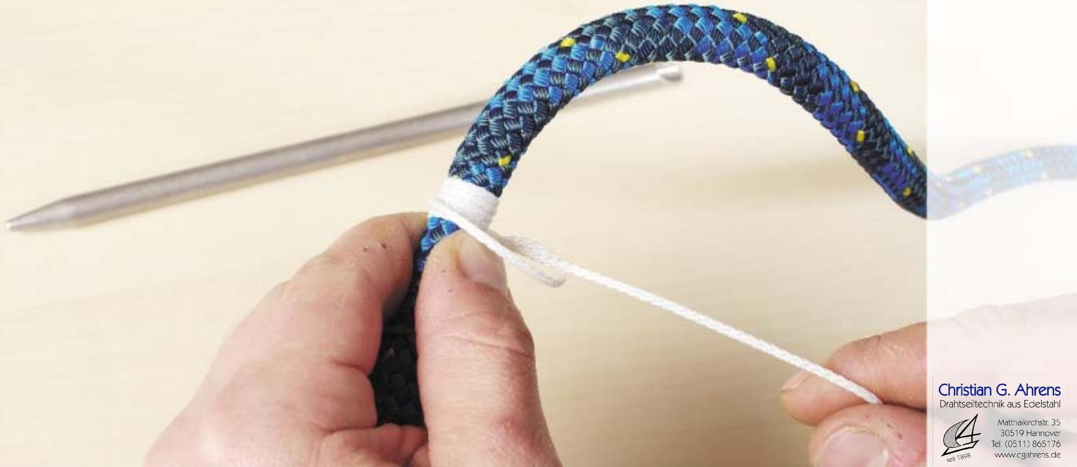
Nach einer Länge von  $40 \times$  Seildurchmesser ein erstes Takling setzen.
