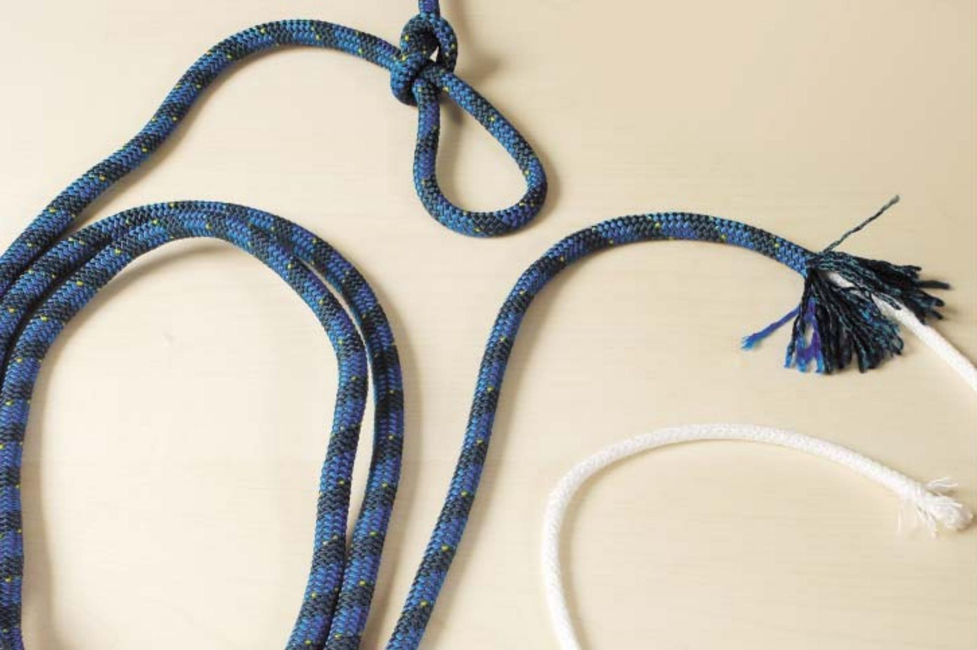
Eine Länge von  $80 \times$  Seildurchmesser + Auglänge herausziehen.
