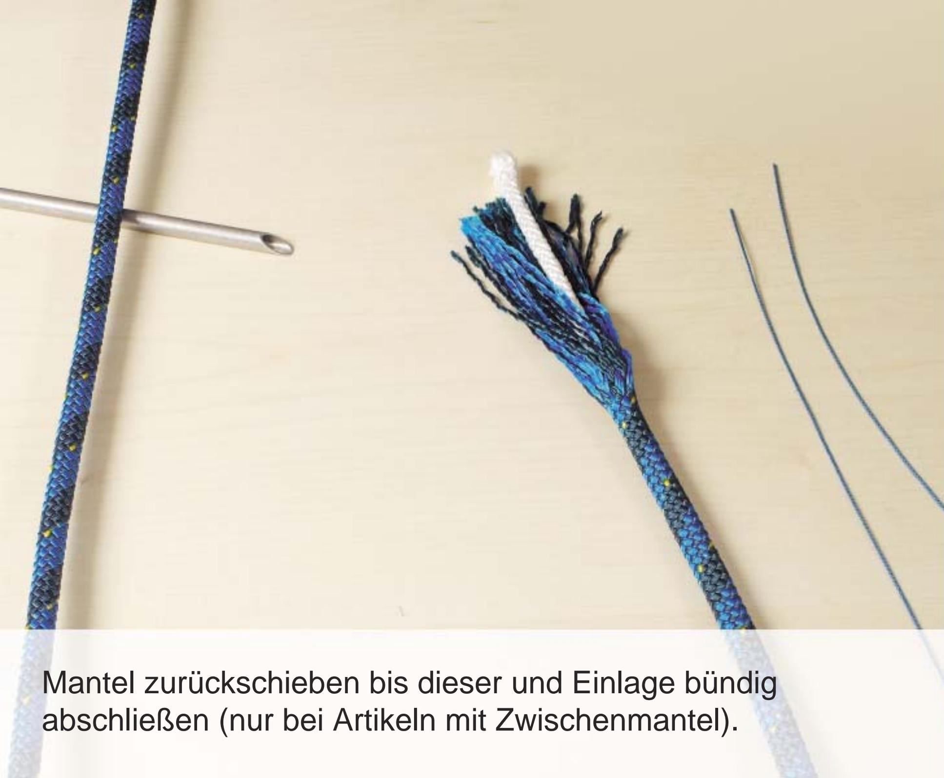
Mantel zurückschieben bis dieser und Einlage bündig abschließen (nur bei Artikeln mit Zwischenmantel).
