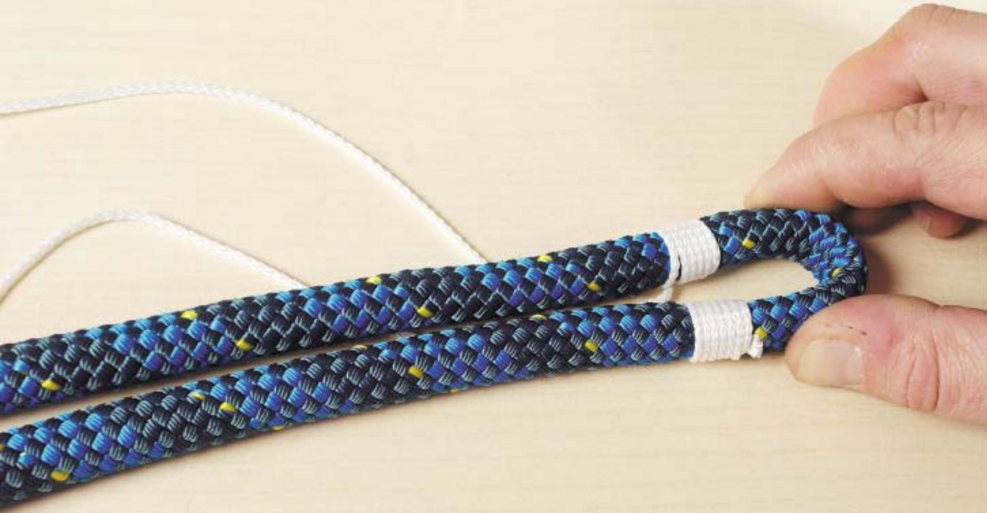
Beim Einspleissen einer Kausche müssen die beiden Taklings So gesetzt werden, dass die Kauschenöffnung an den unteren Enden der Taklings anliegt.
